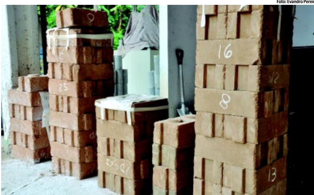
Estudantes da UFPB trabalham em pesquisa que utiliza terra crua para produzir blocos para a construção civil
