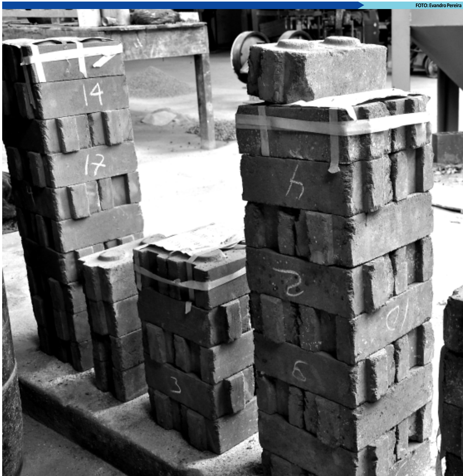
Pesquisa desenvolvida pela UFPB utiliza terra crua, estabilizada com cimento, para formar blocos que são usados na construção civil
