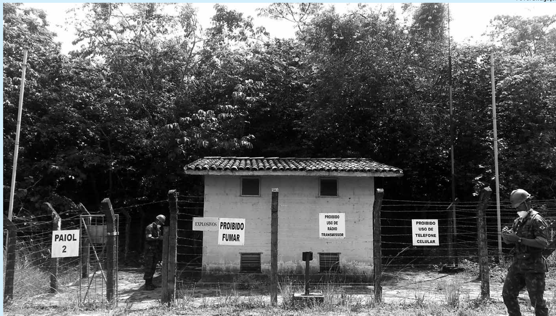
Paiol de uma empresa da construção civil, em local reservado, onde são armazenados pólvora e derivados, como dinamites, por exemplo, usadas em pedreiras
