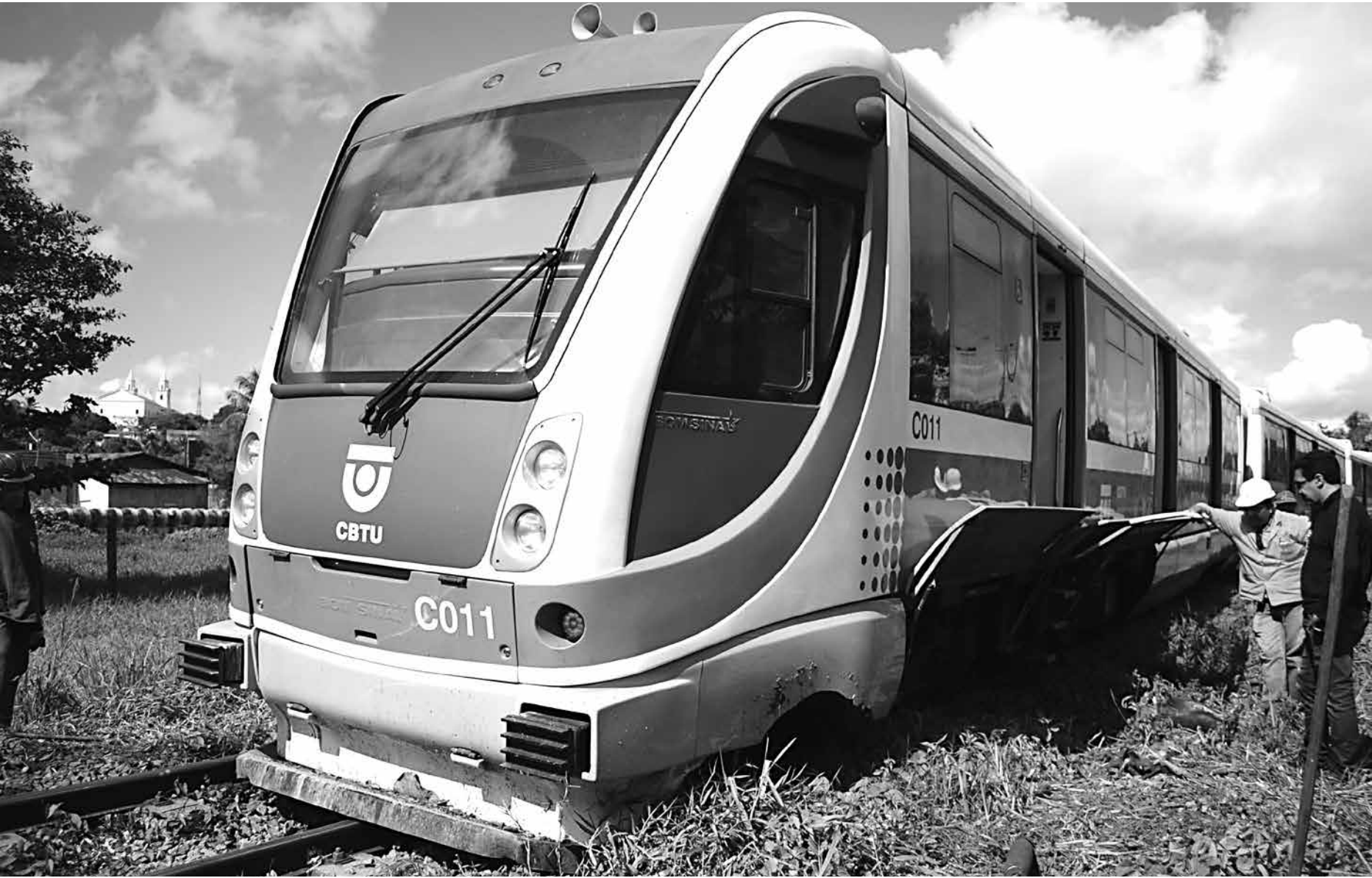
Após o descarrilamento, o trem ainda trafegou por cerca de cem metros com a roda traseira fora dos trilhos. O maquinista ao perceber um balanço diferente acionou o freio
