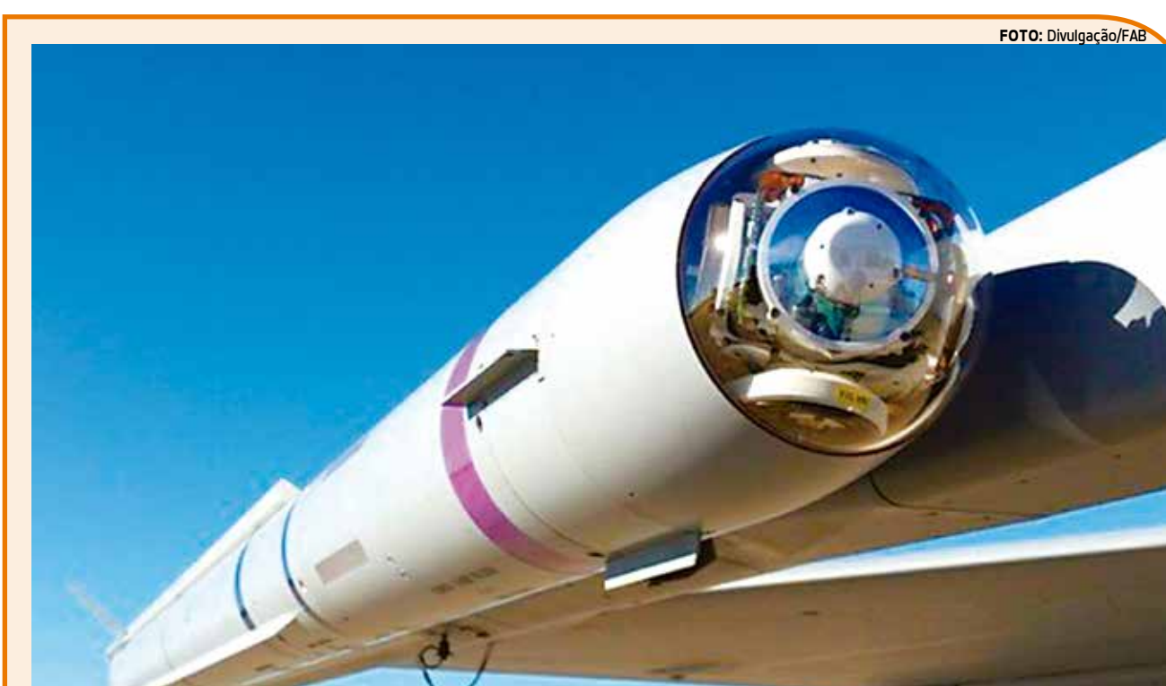
A-Darter é um míssil capaz de atingir aeronaves que estejam se aproximando por trás do avião lançador
