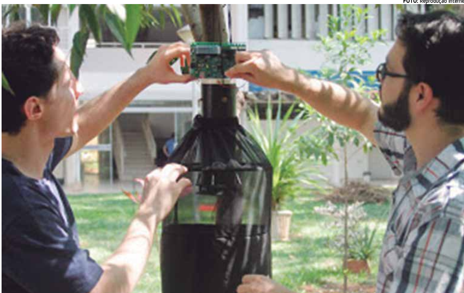
Armadilha desenvolvida pelo professor Gustavo Batista é capaz de identificar a espécie e o sexo do mosquito pelo movimento de asas
