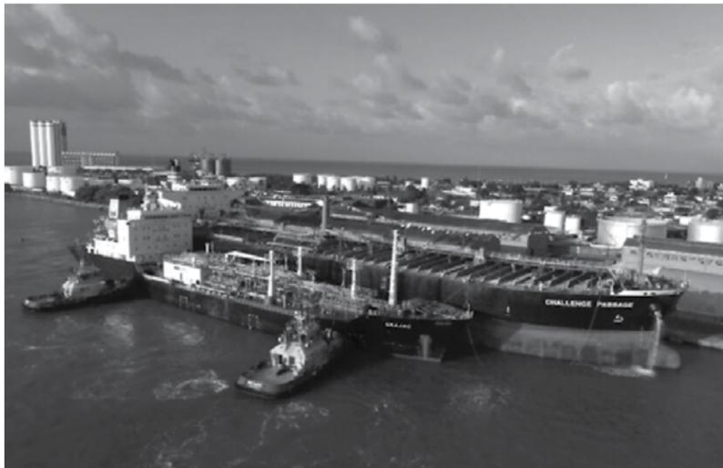
A operação Ship to Ship é a transferência de carga de petróleo e seus derivados entre embarcações
