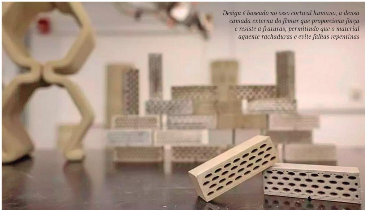
*Design é baseado no osso cortical humano, a densa camada externa do fêmur que proporciona força e resiste a fraturas, permitindo que o material agente rachaduras e evite falhas repentinas*
