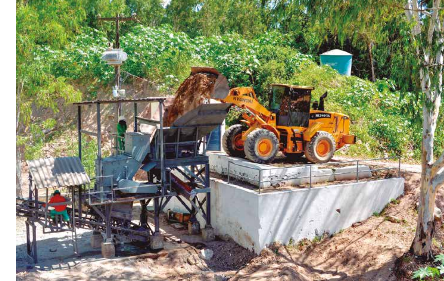
A Usiben, usina responsável pelo processamento e reciclagem desse tipo de resíduo, tem capacidade instalada de 20 m³ por hora
