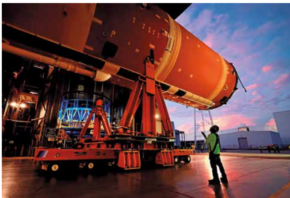
Técnicos içam o estágio central do foguete usado no lançamento da Artemis II
