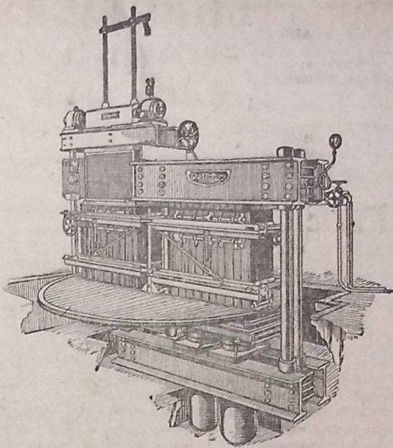
electrico ou mechanico, cuja potencia é de 25.000 kilos de compressão. Produz de 6 a 8 fardos por hora, de 200 kilos cada um.
