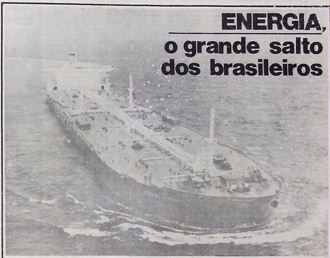
O Vidal de Negreiros, um dos superpetroleiros da Petrobrás, com capacidade para transportar cerca de 270 mil barris de petróleo em seu bojo
