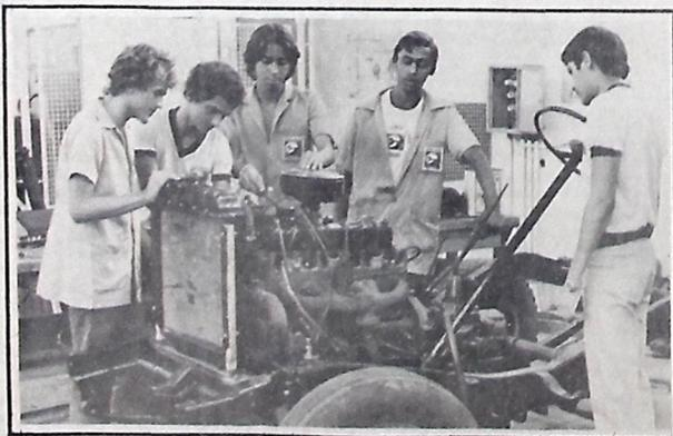
Nas aulas práticas de mecânica, alunos recebem o máximo de informações e aprendizado de base sobre como se desmontar o motor de um automóvel
